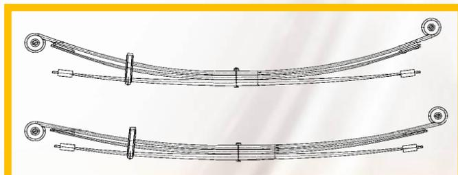
Véhicule en charge avec lame de renfort
